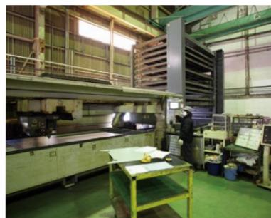
2001年に導入した三菱電機の3.5kW CO<sub>2</sub>レーザ加工機「ML3015LZP」。すでに17年も使い続けているが、いまだに現役だ。
