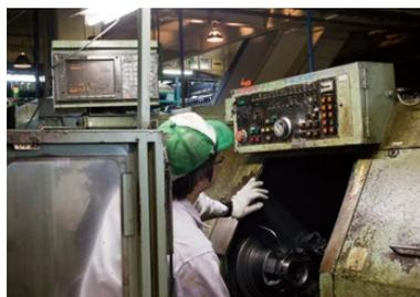
20年以上も前に導入したFUJI製のCNC旋盤。CNCはオーバーホールを施した三菱電機の「320L」だ。
