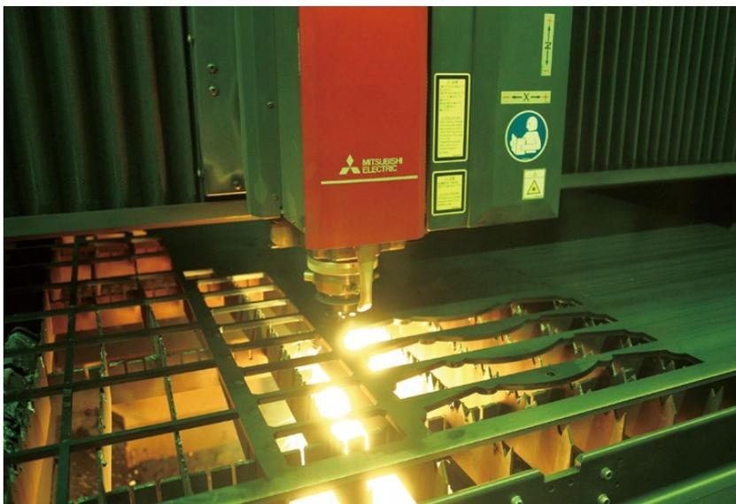
銅板を加工中の「ML3015eX-F60」。銅板の種類によっては、従来機種約10倍の速度で加工することが可能だ。
