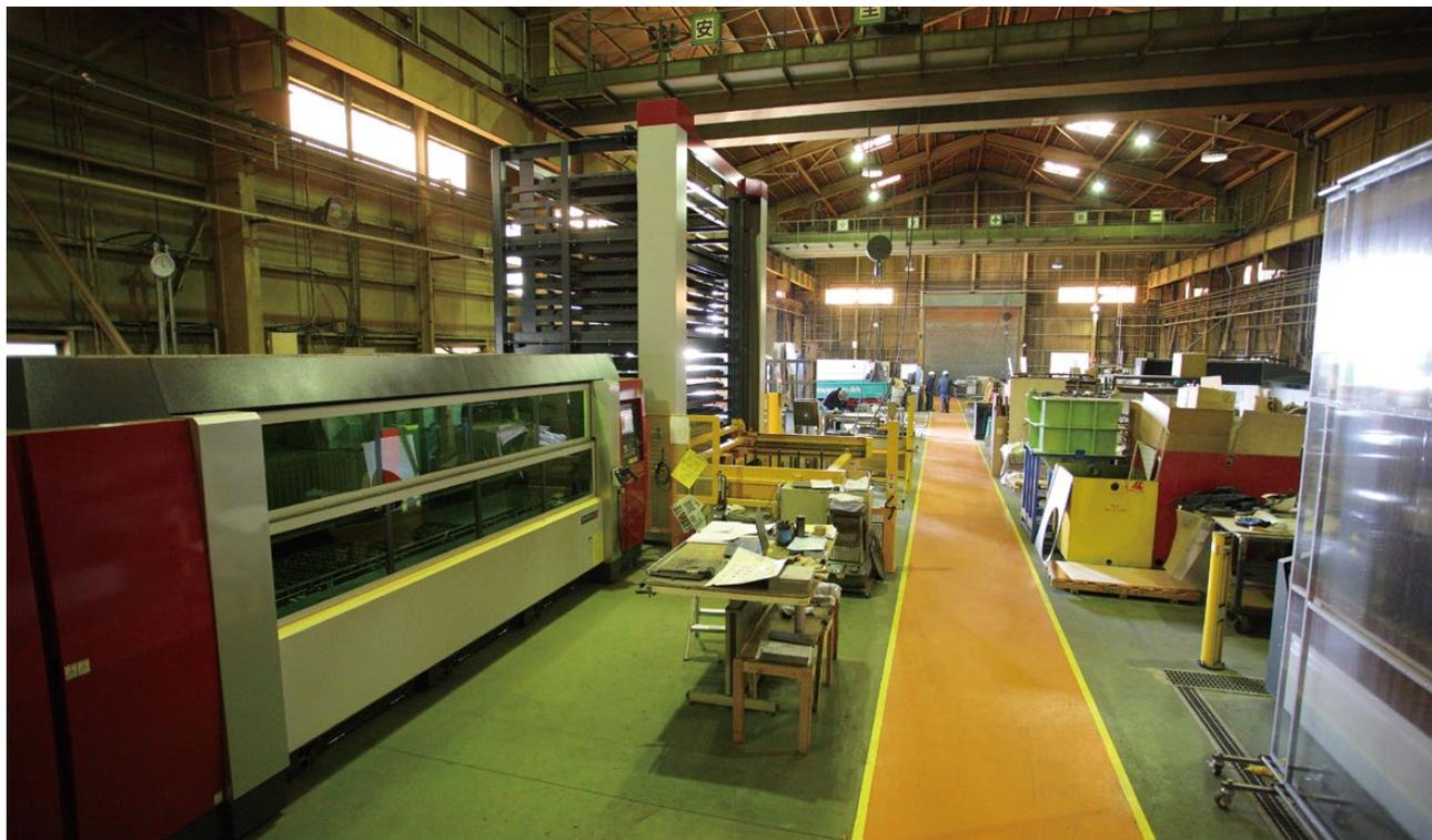
鉄・非鉄・非金属の加工を担当する第一カンパニーの工場。3台のレーザー加工機のほか、ウォータージェット加工機も稼働している。
