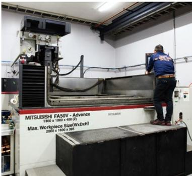
2000×1600×395mmという超大型ワークまで加工することができるワイヤ放電加工機「FA50V ADVANCE」。
