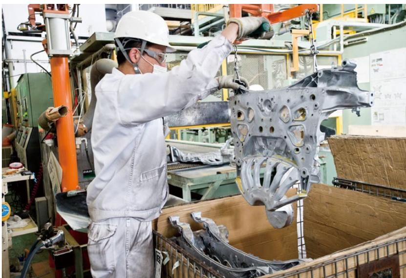
ハイプレッシャーダイカスト装置で製造したアルミ中空サブフレーム。この後ターレットセンターで機械加工を施し仕上げていく。
