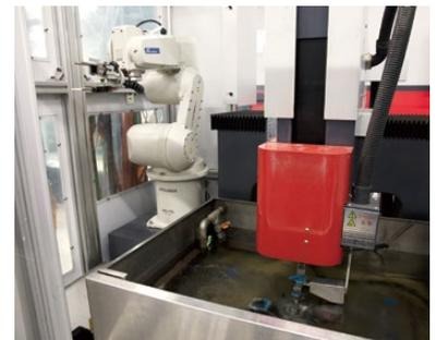
電極を自動交換できるロボットアームを装備した細穴放電加工機「EMACH」。直径0.2mmまでの細穴を加工することができる。
