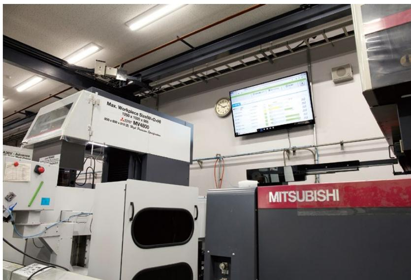
事務所と工場内に50インチのモニタを設置。加工機の設置場所まで行かなくても、稼働状況が確認できるため、ムダな動きがなくなった。
