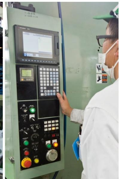
アルミ中空サブフレームの機械加工に活用しているファースト技研の複合加工機「BT#40ターレットセンター」。三菱電機のCNC「M70」を搭載している。
