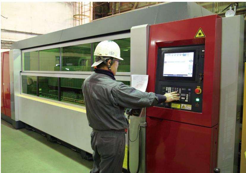
2017年3月に導入した三菱電機の6kWファイバレーザー加工機「ML3015eX-F60」。ズームヘッドを搭載しているため、段取り替え時間を大幅に短縮できる。
