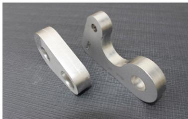
ステンレス加工の例。左が板厚20mm、右は16mm。板厚と同サイズの穴あけ加工まで保証しており、用途によっては半分の穴径まで加工可能だ。
