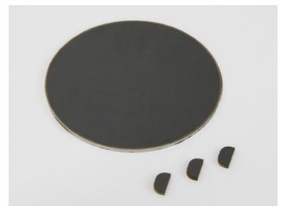
ワイヤ放電加工機でダイヤモンドエハから切り出されたダイヤモンドチップ。
