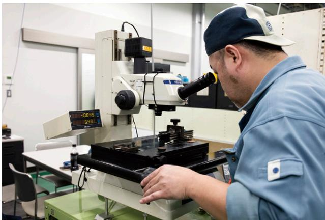
ダイヤモンド切削工具の製造工程。工業用ダイヤモンドの刃をワイヤ放電加工機で加工し(左)、顕微鏡で精度を確認。この作業を繰り返して仕上げていく。
