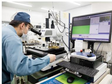
出荷前の最終検査工程。ベテランの担当者が、ディスプレイで拡大表示した顕微鏡画像から加工精度を確認する。
