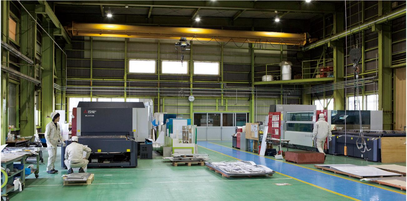
もらい錆を防ぐため、「ML3015eX-F40」と6kWのCO<sub>2</sub>レーザー加工機「ML3015eX-60XF」は、他の3台とは別の工場棟に設置している。「ML3015eX-60XF」はステンレス加工専用機だ。
