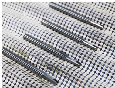
製造が終了したばかりのダイヤモンド工具。超硬合金の工具本体にダイヤモンドチップをろう付けて製造する。
