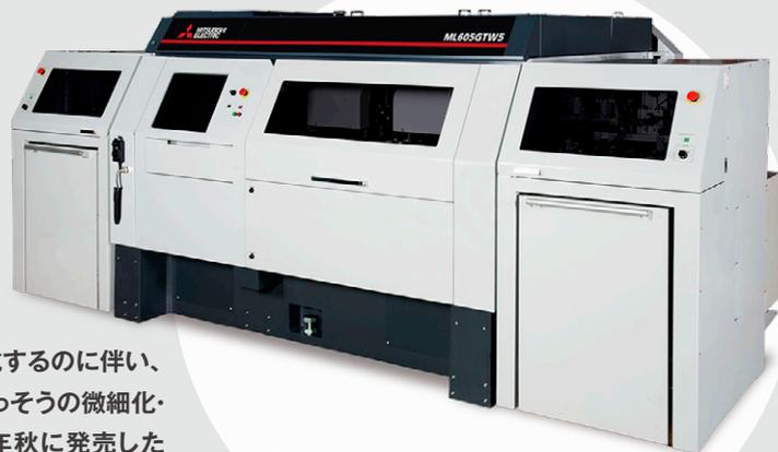
▲「Synchrom (シンクローム) テクノロジー」の採用などで、生産性を20%向上させた三菱電機の新しい基板穴あけ用レーザー加工機「ML605GTW5シリーズ」。
