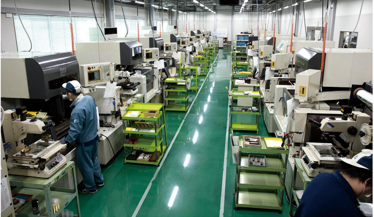
ダイヤモンド工具の製造ライン。20台のワイヤ放電加工機が並んでいる。うち19台が三菱電機製だ。
