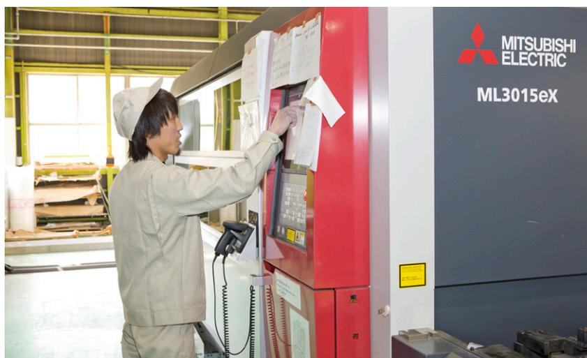
鉄やステンレス以外の素材加工に業務を拡大するため、2015年に導入した三菱電機の4kWファイバレーザー加工機「ML3015eX-F40」。
