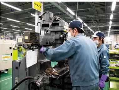
技術は基本的にOJTで伝承する。写真は超硬合金製の工具本体の機械加工工程でOJTを実施している様子。
