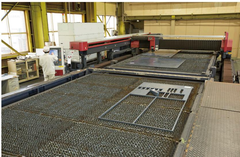
大形レーザー加工機「ML6030XL-45CF-R」は最大6100mm×3050mmの素材まで加工可能。しかもパレットチェンジャ付きだ。
