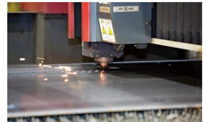
出力4.5kWの「ML6030XL-45CF-R」。生産部長の廣岡氏は「三菱電機のレーザー加工機はビームの質がいい」と評価している。
